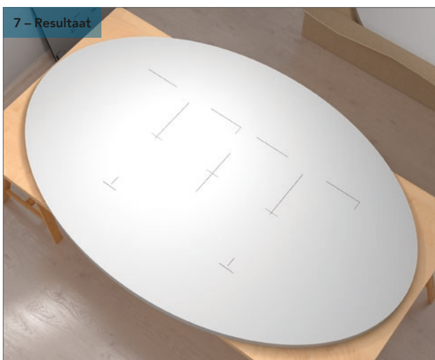
Teken 300 mm links en rechts van het middenkruis af.
